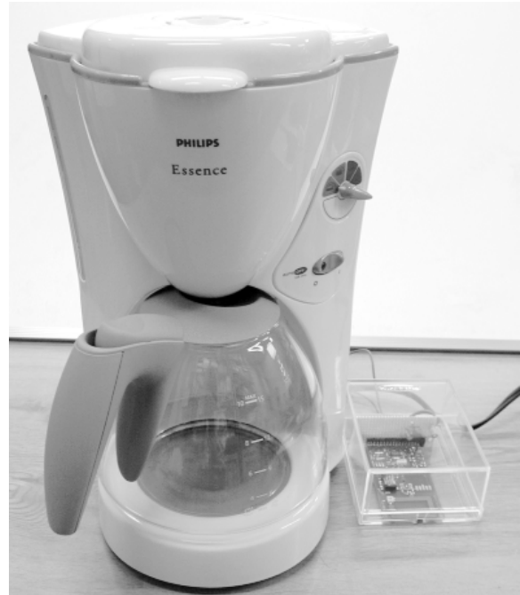
図1. 発信器付きコーヒーマーカー。コーヒーが抽出される状況を、無線発信器により伝達する。
