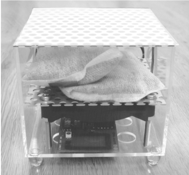
図2. コーヒーアロマ発生器。コーヒーメーカーからの信号を受けて、コーヒーの芳香を提示する。
