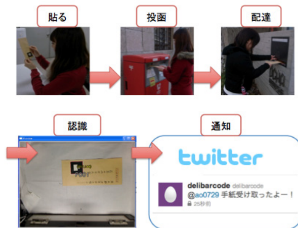
図2. DeliBarcodeのコンセプト. 差出人は2次元コード(差出人コード)を手紙に張り付けて送付する。郵便箱では2次元コードを自動認識し、手紙の到着を差出人/受取人の双方にWeb経由で通知する
