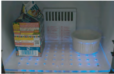
図 6 LED を用いた情報提示の様子。各 LED が異なる周期で点灯する
