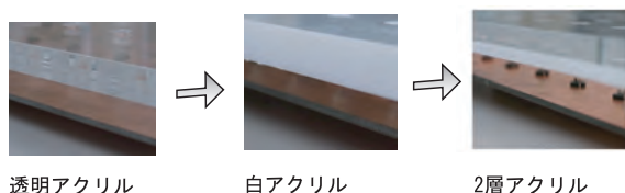
図 7 アクリル板の遷移。アクリル板によってセンシング／情報提示性能に大きな影響があった。
