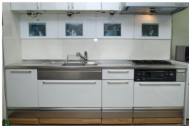
図 1: 試作したキッチンシステム。カップボード下にカメラとマイクロフォン、正面壁に LCD、足下にフットスイッチが設置されている
