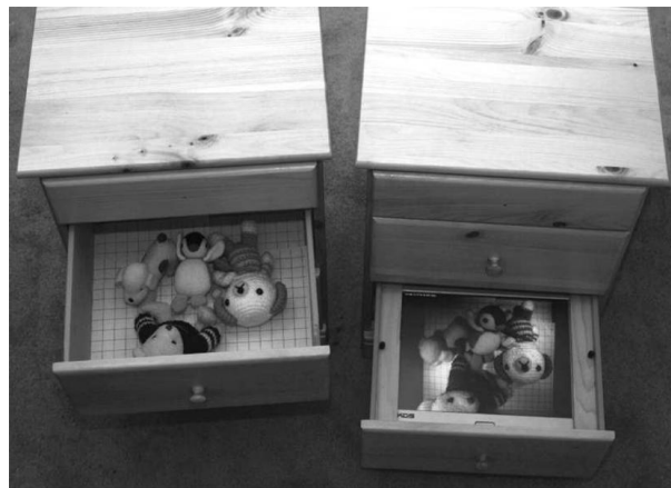
図3 Peek-A-Drawer。ネットワーク接続したキャビネットの上の引き出しの内容が、もう一方の下の引き出しのディスプレイに表示される。
